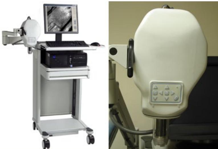
**Foto 2.** Microscopio confocal de última generación (Vivascope® 1500).
